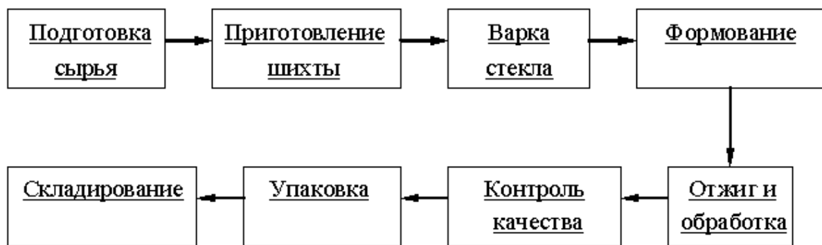
Рисунок 1. Типовая технологическая схема промышленного способа получения стекла
