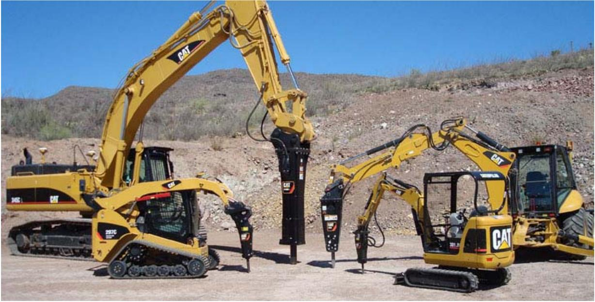
К легкому классу обычно относят гидромолоты массой до 400-500 кг, предназначенные для навески на мини-погрузчики, экскаваторы-погрузчики и полноповоротные экскаваторы массой до 10-12 т. Энергия удара гидромолотов легкого класса разных моделей составляет от 100 до 1000 Дж. Диаметр рабочей части инструмента обычно находится в пределах от 40 до 90 мм.
