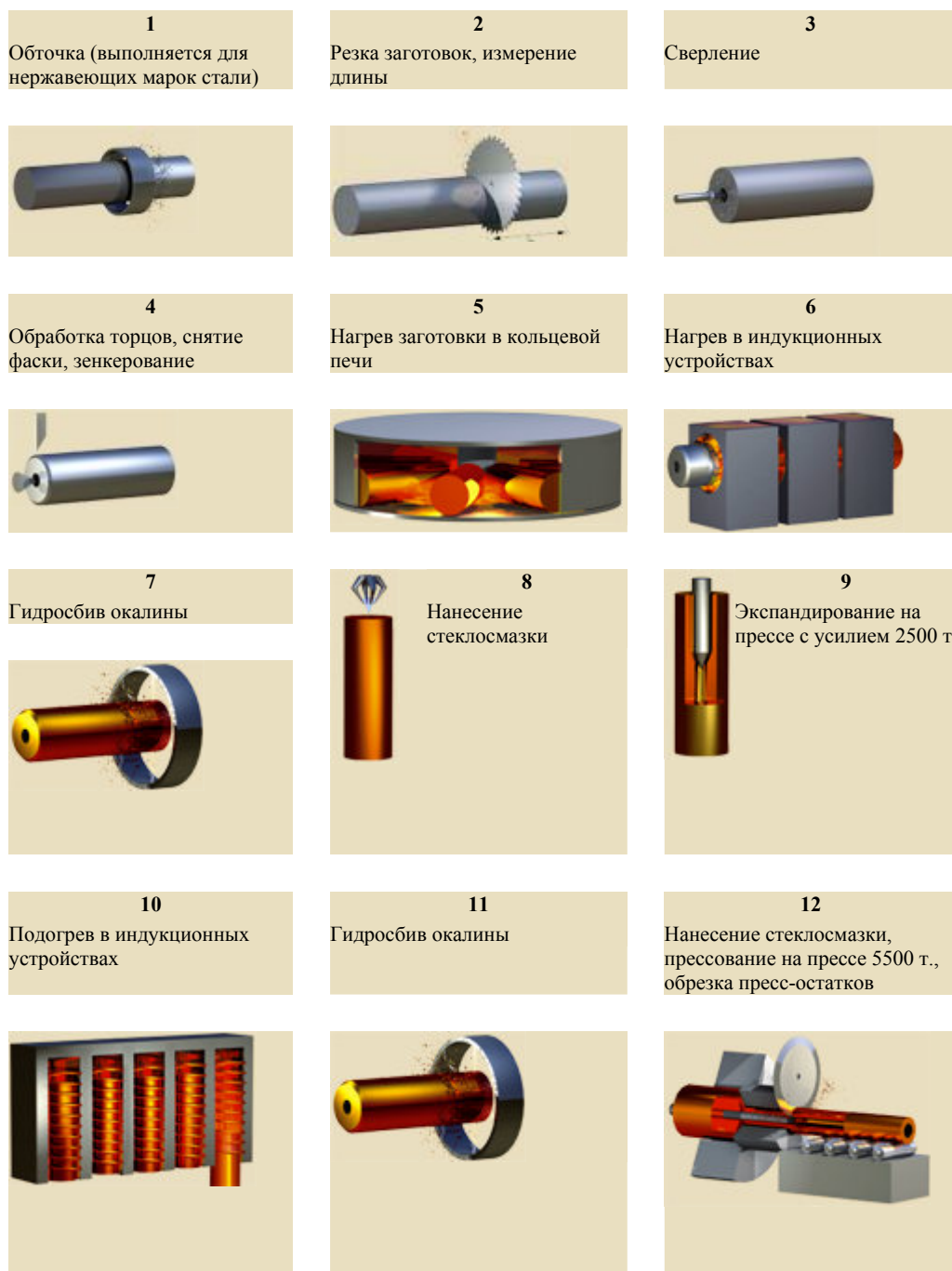
Рисунок 1. Технологическая схема производства бесшовных нержавеющей труб на ВТЗ
